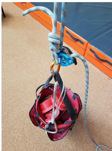
Bouw tas gefixeerd met zekeringsapparaat aan naburig touw
