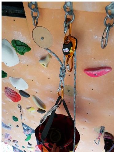
Hijzen met katrol (met teruglooprem)
