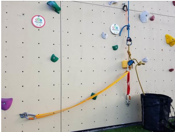
Rig to rescue; ankerpunt met back-up.
