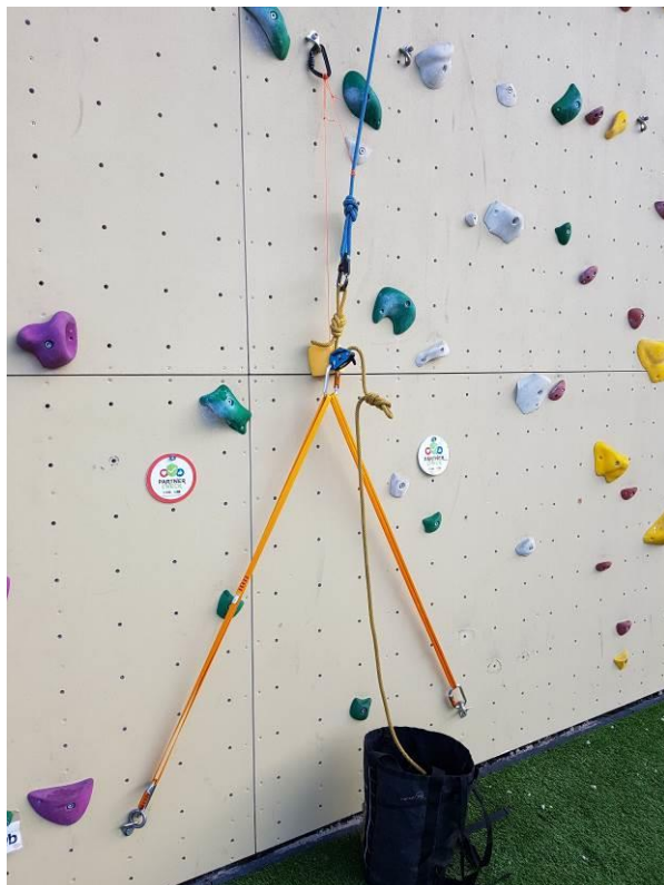
Rig to rescue; redundant ankerpunt.
