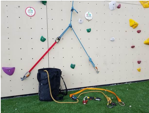
Redundant ankerpunt met vooraf geïnstalleerde vlinderknoop voor redding. Reddingstas voorbereid.
